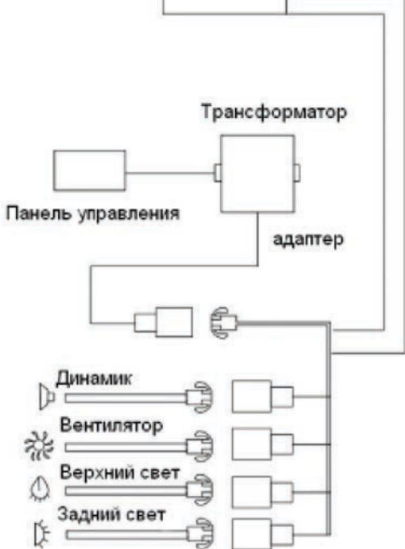
**1.** Включение и вентилятор: включите питание, для включения света или вентилятора нажмите соответствующие кнопки, для выключения функции нажмите соответствующую кнопку ещё раз.
