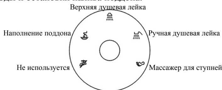
Рис. 2 Функциональные положения вентиля налива (распределения воды)
